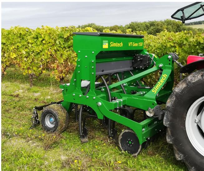
Le **VT-Sem** est équipé de dents semeuses réparties sur 3 rangées, éventuellement précédées de disques ouvreurs (option). Les roues garantissent la stabilité et le contrôle de profondeur. La herse à chaîne lourde assure la finition: fermeture du sillon et dispersion des débris végétaux.
